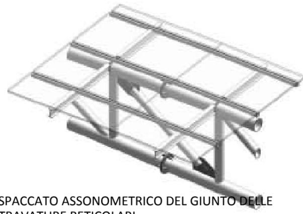
SPACCATO ASSONOMETRICO DEL GIUNTO DELLE TRAVATURE RETICOLARI
